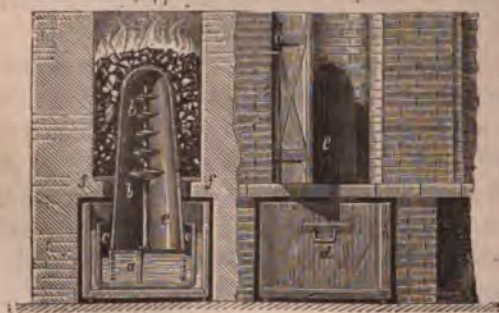
Fig. 256. — Distillation de l'amalgame d'argent (méthode saxonne).
